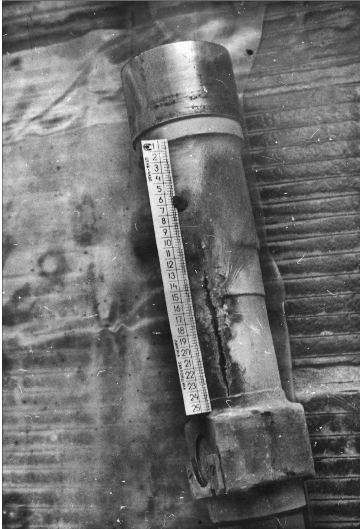
Фотографії пошкоджених фрагментів ротора турбогенератора № 1, 4 вересня 1982 р. ГДА СБУ. — Ф. 11. — Спр. 992. — Т. 6.
